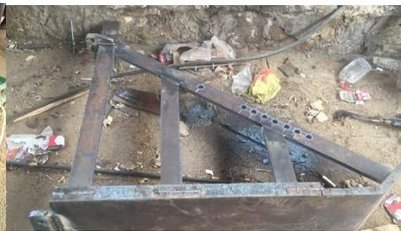
Adecuación de los equipos de pesca; instalación de la segunda relinga construcción de patines adecuados a las puertas experimentales de acero.
