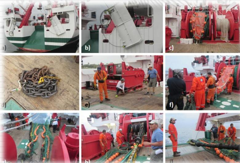
Figura 12. a y b) Puertas de arrastre instaladas en posición de trabajo; c) Redes de arrastre de fondo y media agua, instaladas en los carretes de pesca; d) Contrapesos para la red de media agua; e y f) Maniobras de preparación de lance de prueba de red de fondo; g, h e i) Lance de pesca con red de fondo.
