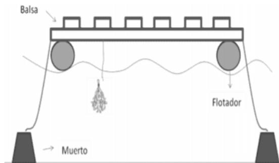
En ocasiones, los flotadores se colocan de manera intercalada en las vigas. Las balsas se encuentran sujetas al sistema de anclaje a través de cabos de fondeo amarrados a estructuras de concreto denominadas “muertos”. En este arte de cultivo se pueden colgar sargas sencillas, en racimos o módulos de cajas o cestos ostrícolas.
