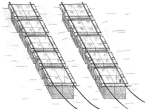
**Dimensiones:** Las dimensiones que se manejan varían entre 3.0 m x 2.5 m x 1.2 m (7.5 m<sup>3</sup> de capacidad efectiva), o 4 m x 4 m x 3 m, con una luz de malla de una pulgada en los costados y una pulgada en la tapa, esto puede variar de acuerdo a la producción.
