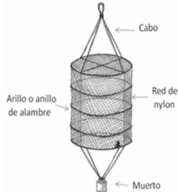
**Dimensiones:** Generalmente, el diámetro del cilindro es de 40 cm y la altura varía dependiendo del número de arillos que contenga la estructura y de la profundidad del mar. La distancia entre los aros o anillos divisores es aproximadamente de 10-20 cm entre cada uno.
