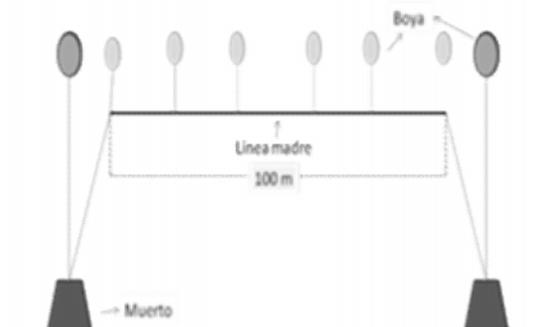
**Descripción:** Estructura flotante trapezoidal, que consiste en un cabo de polipropileno o nylon de 5-8 plg de diámetro. Este cabo principal se conoce como línea madre, puede ser simple o doble, y es suspendido en la columna de agua a una determinada profundidad del mar. El sistema de
