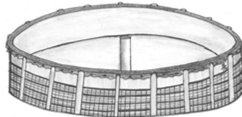
La estructura perimetral metálica, suele ser de malla de acero electrosoldada y galvanizada con postes tubulares, y tiene la función primordial de dar soporte y forma cilíndrica a la "bolsa" de la geomembrana, así como tolerar la presión del peso del agua contenida en el estanque, por lo que se requiere estar sobre una base firme o terraplén. Algunas estructuras de soporte cuentan con cinturones de acero galvanizado de una pulgada para el refuerzo estructural de la malla.
