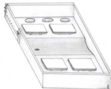
**Dimensiones:** Este tipo de edificios se divide en tres secciones: 1) Una serie de 3-5 tanques de 25 m<sup>2</sup>, para mantener los reproductores separados por sexo. 2) Un área colectiva de reunión para machos y hembras. 3) Una serie de tanques pequeños (1 m<sup>2</sup>) charcos para desove.
