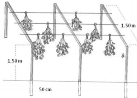
En estas estructuras se colocan, en la parte superior y perpendicularmente travesaños o vigas del mismo material de construcción para amarrar las artes de cultivo. En el caso de las sargas, se instalan con una separación de 30 cm entre cada una, colocando aproximadamente 110 sargas por rack. Los racks se instalan en línea recta, siguiendo la profundidad adecuada sobre la zona intermareal, localizando las cotas de nivel de  $\pm 0.4$  y  $\pm 0.3$  m, con respecto al nivel medio del mar.
