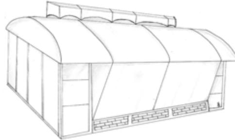
**Características:** Los tanques dentro del invernadero pueden ser de madera o concreto, generalmente de 25 m<sup>2</sup>, con el piso parcialmente inundado. La temperatura ambiental dentro del invernadero oscila entre los 28 y 42 °C, la del agua entre 26 - 28 °C, la humedad ambiente 95-98 %, y el fotoperiodo dependerá de la utilidad del invernadero (reproducción o engorda).
