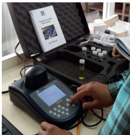
FIG. 7. Equipo portátil para registro de amonio total ( \text{NH}_3/\text{NH}_4^+ ), nitritos, nitratos, dureza, entre otros.
