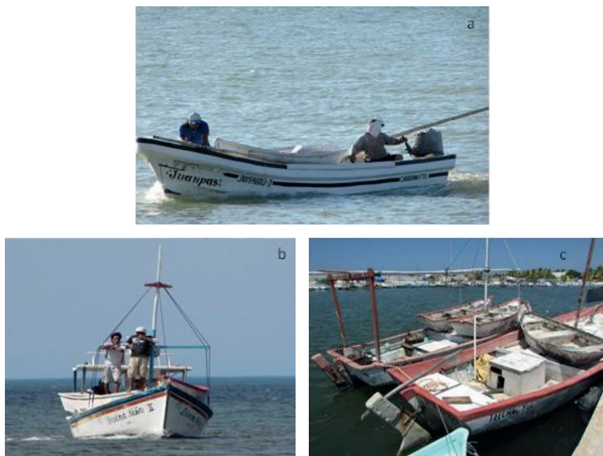
Fig. 10. Embarcaciones utilizadas por la flota ribereña; a) de fibra de vidrio con motor fuera de borda; b y c) de madera con fibra de vidrio impulsada con motor estacionario de diésel.
