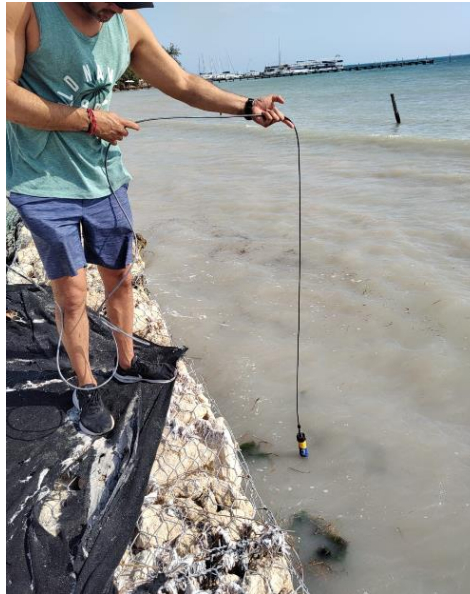
Figura 7. Verificación del correcto funcionamiento de la sonda multiparamétrica.
