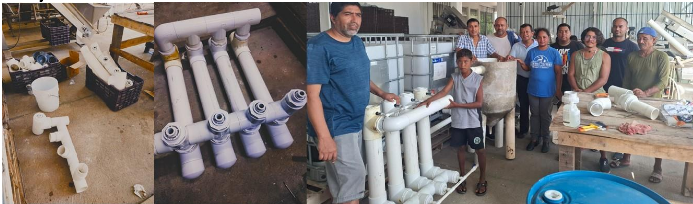
Ensamblado del filtro de arrastre en cámaras, y sistema de recirculación, con el equipo de trabajo.
