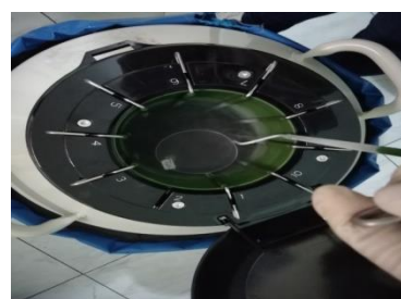
Tanque de nitrógeno líquido donde se almacenan las muestras de esperma
