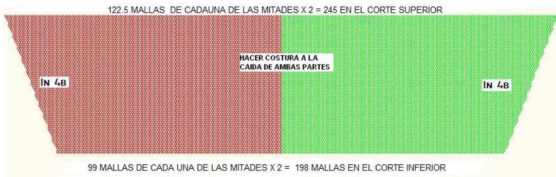
**Sección (n°3 b).** Una pieza formada por 2 mitades cielo (dibujo ant.)
