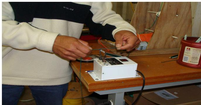
Foto 7. Cortador de calor para hilos Nylon
