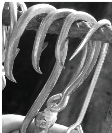
Fig. 2. Anzuelos utilizados en el experimento. De izquierda a derecha: C18/0, C16/0, C14/0 y recto (también llamado "J"). Nota del editor: El largo y ancho de los anzuelos circulares es: 18/0: 74 y 63 mm; 16/0: 59 y 55 mm; 14/0: 50 y 42 mm.
