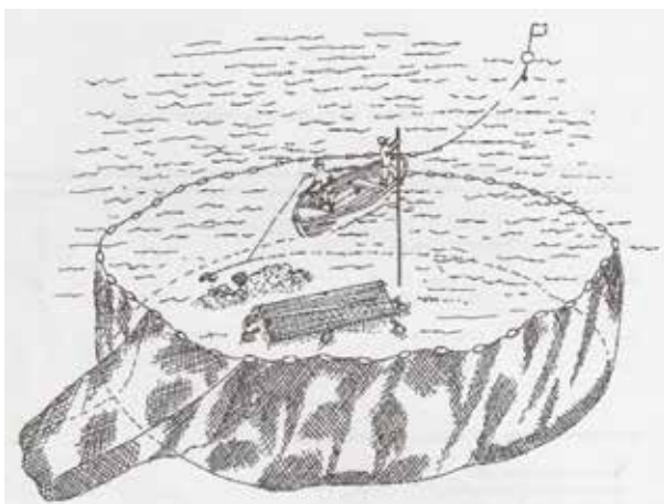
FIGURA 8. Chinchorro con copo utilizado para cosechar las "casitas" o sombras (figura tomada de Caballero y Aldama, 1994).
