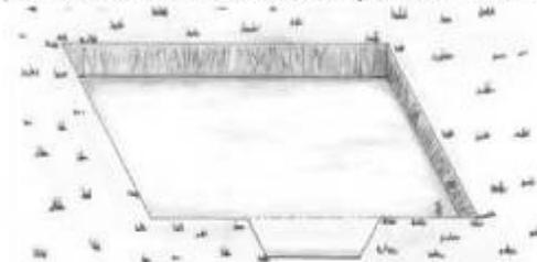
paredes tengan una inclinación o talud de 3:1. Es necesario contar con una fuente segura de abastecimiento de agua, garantizando un aforo suficiente para lograr un recambio diario de por lo menos un 10% del volumen total del estanque, con el fin de eliminar excesos de amoníaco y materia orgánica.
