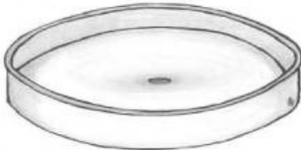
**Características:** En la instalación de los tanques se requiere la preparación del terreno, una cimentación, sistema de drenaje y el acabado fino de las paredes internas y del piso, así como especificaciones de construcción, que varían según el tipo de material utilizado, ya sea concreto armado o mampostería de block.
