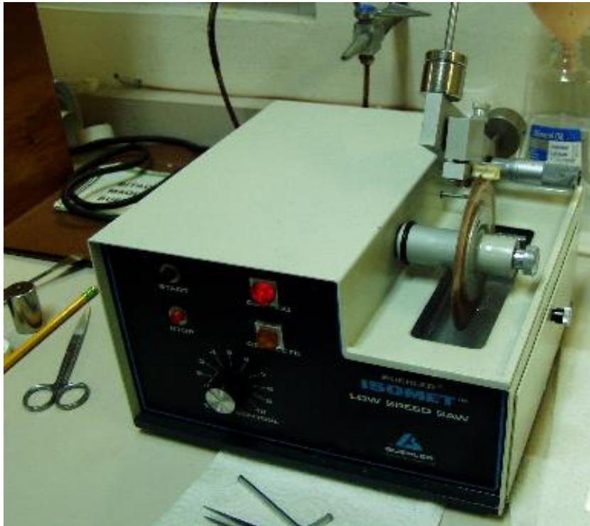
**Fig. 6.- Cortadora Isomet con cuchilla de borde de diamante utilizada para el corte de vértebras.**
