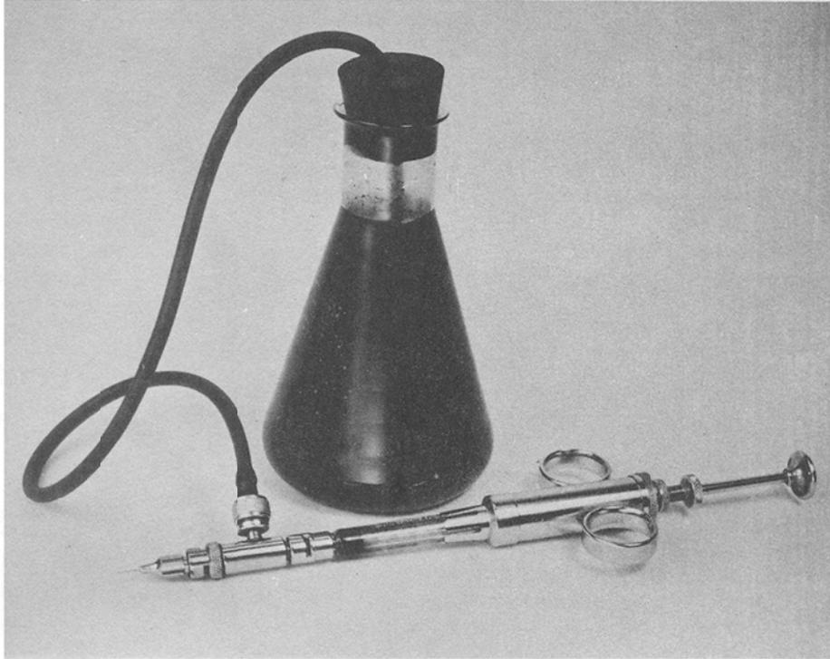
Fig 2 Dispositivo pipeta utilizado para una rápida inyección de colorante biológico.
