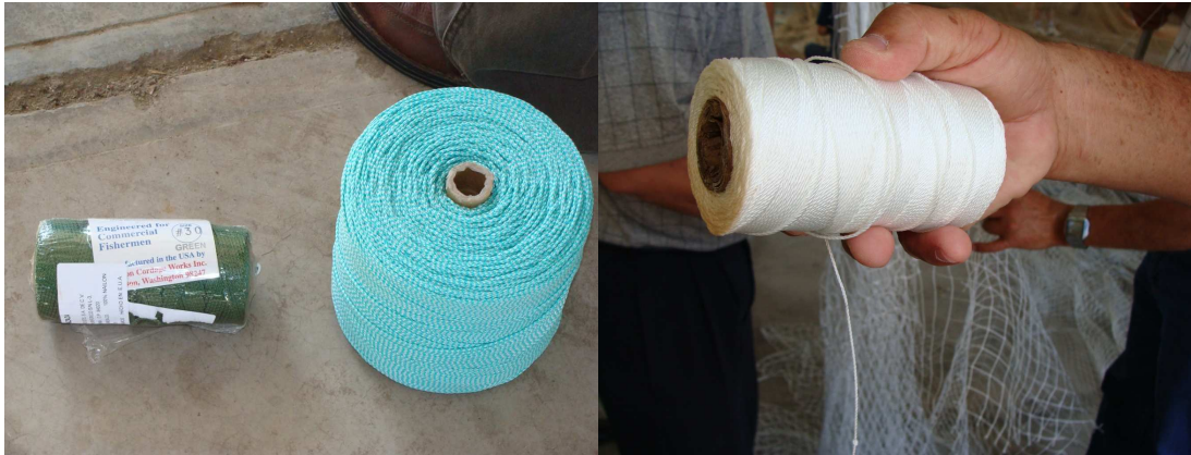
Foto 5. Material utilizado para unión de paños: hilo multifilamento Euro-flex y Nylon Trenzado N°30 teñido verde, y blanco
