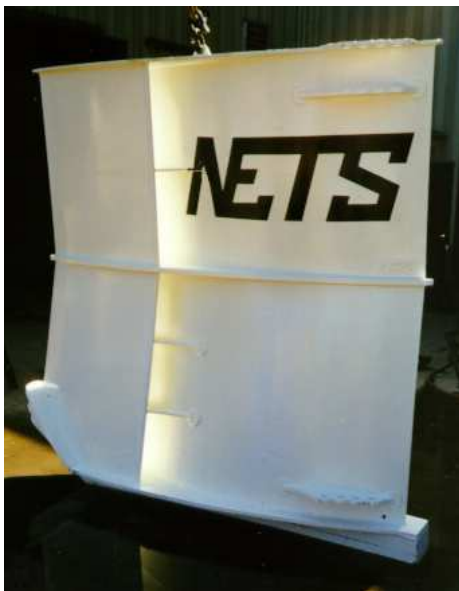
Foto 11. Puerta de arrastre hidrodinámica usada para el prototipo RS-INP-MEX de 110'.
