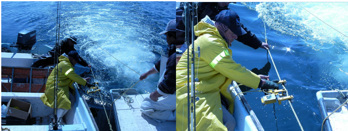
Figura 12. Medición de las fuerzas de arrastre con tensiómetros digitales
