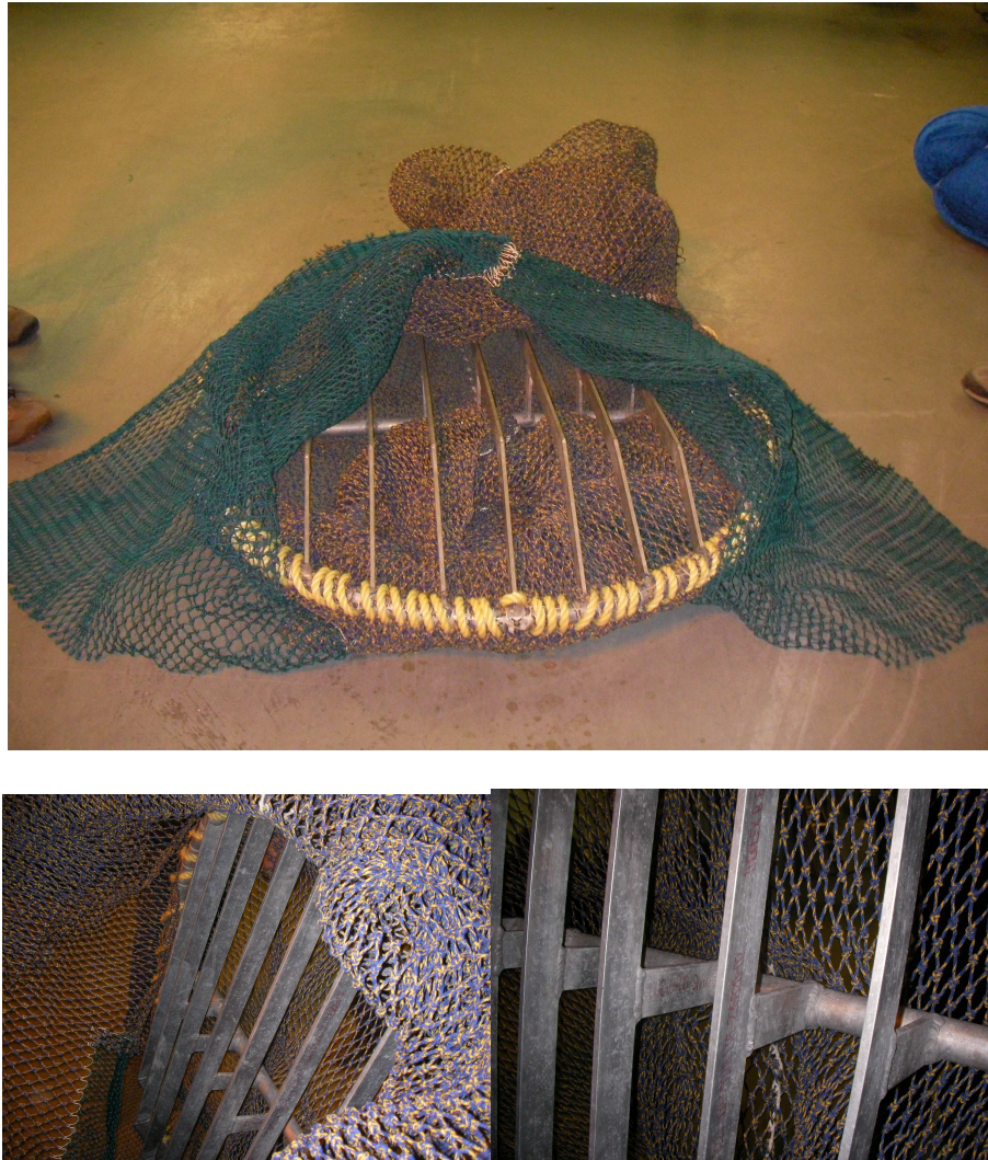
Foto 8. DET diseño Súper Shooter construido con soleras de aluminio
