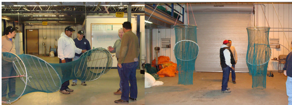
Foto 10. Montaje en serie de dos aros en una maniobra de tensión para armado del DET
