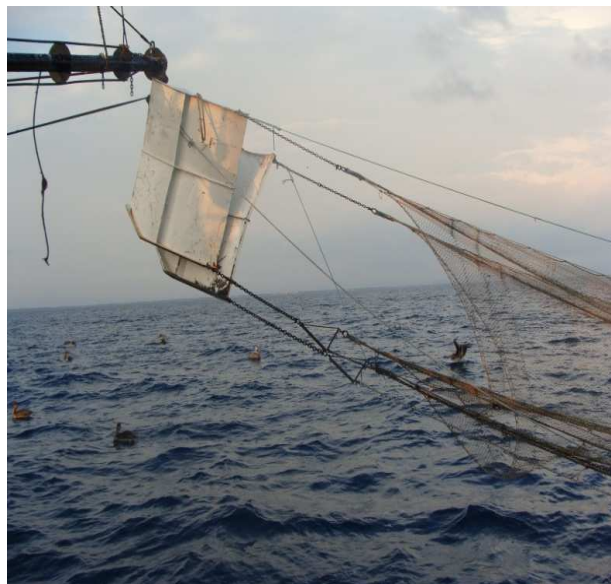
Foto 11. Puerta de arrastre hidrodinámica usada para el prototipo RS-INP-MEX de 110'.
