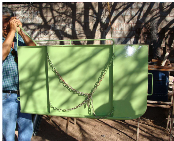
Plano 4. Portones usados en las Pangas con redes de 50". Diseño INAPESCA/Esparza
