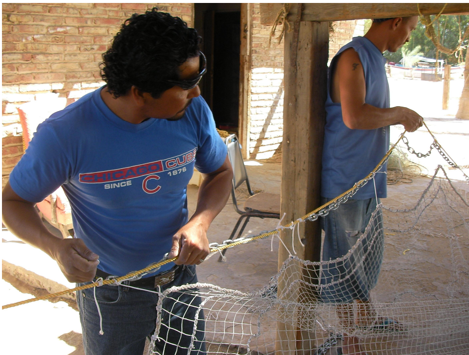
Figura 15. Capacitación a pescadores participantes en el armado de la segunda relinga inferior
