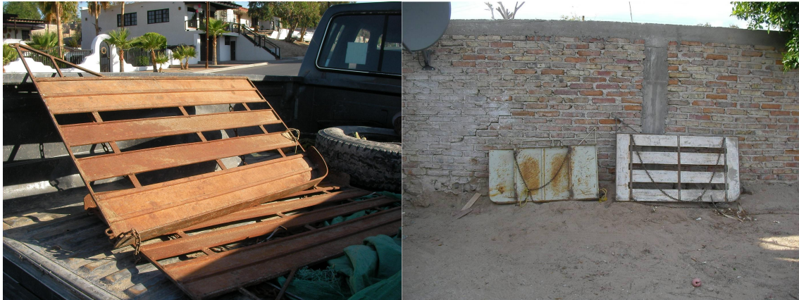
Figura 8. Tablas de arrastre utilizadas durante el estudio. Foto Derecha: puertas del diseño original (izq) y de las utilizadas por los pescadores locales (Der.)
