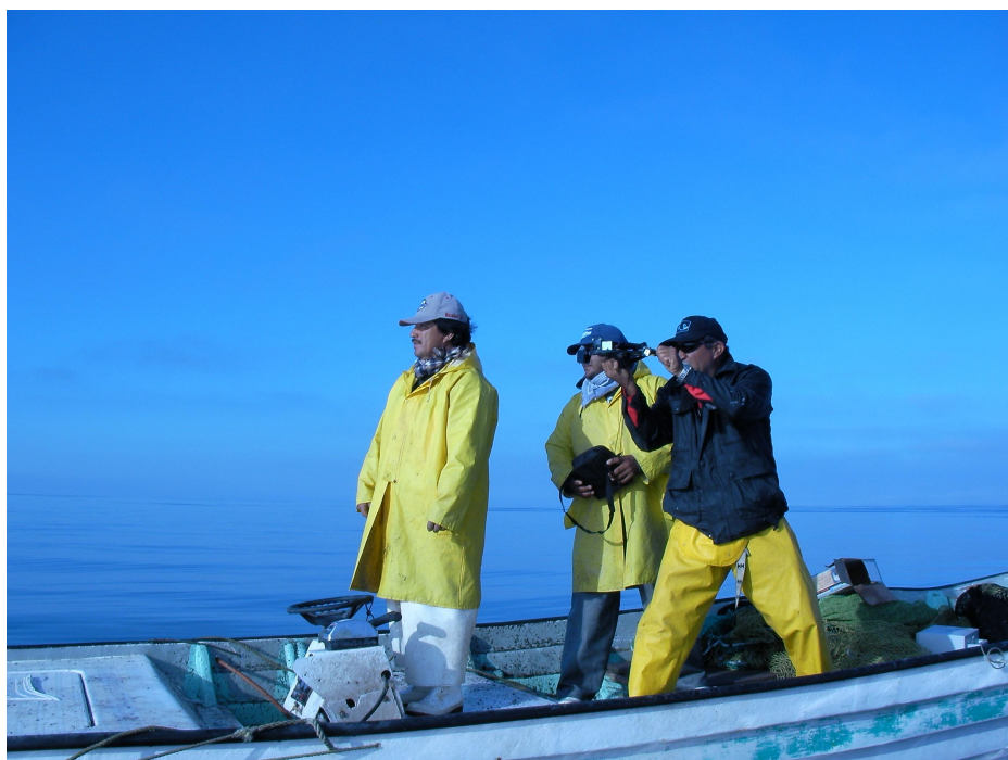
Figura 11. Medición de abertura horizontal de la red por el método de sextante y boyas
