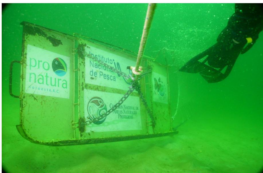
Figura 8. Portones de la red RSINP sin calibrar trabajando en el agua (foto tomada por personal de la NMFS en Panama City USA Junio-2010)
