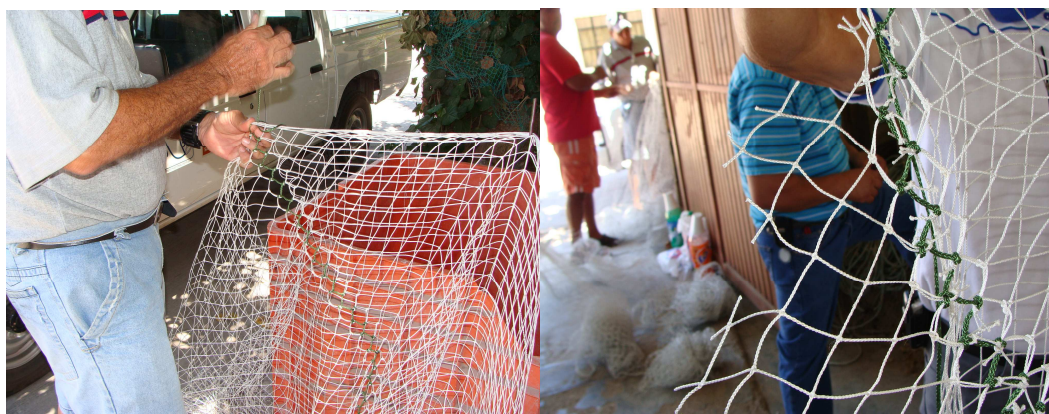
Foto 2. Unión del cuerpo de la red al ante-bolso
