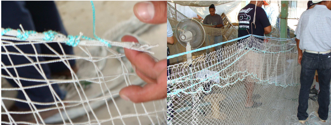
Foto 4. Refuerzos de unión en los bordes del brazo y defensas
