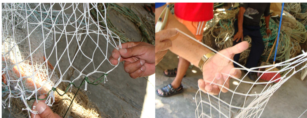
Foto 1. Preparación de mallas y refuerzos para unir las piezas
