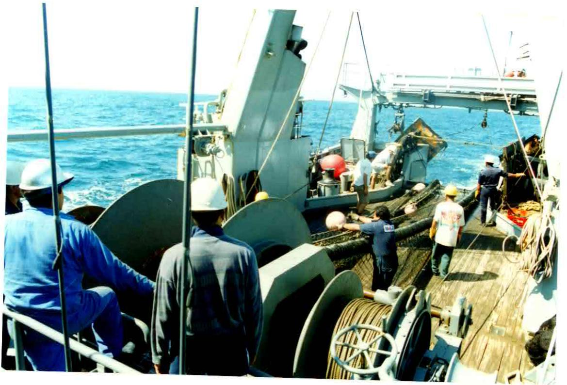
FOTO 3.- Salida del cuerpo de la red de arrastre demersal, tren de arrastre y flotadores
