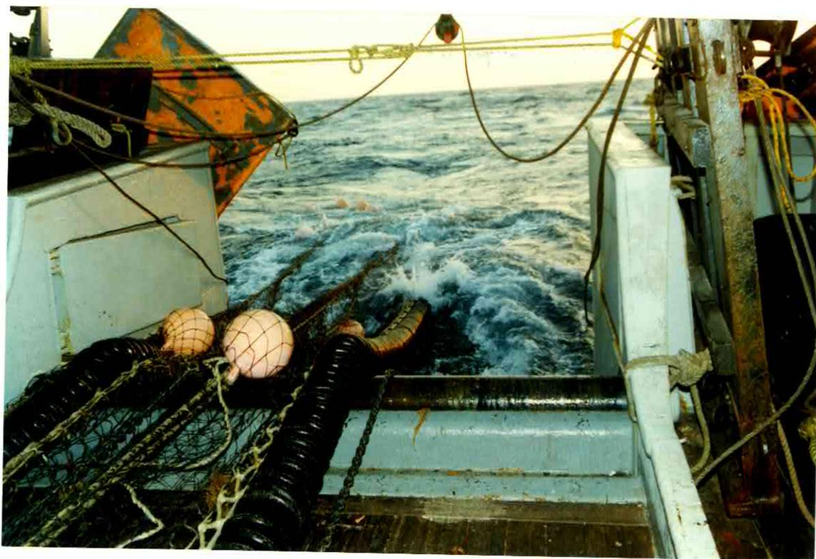
FOTO 6 Cobrado de la red, tren de arrastre y flotadores.
