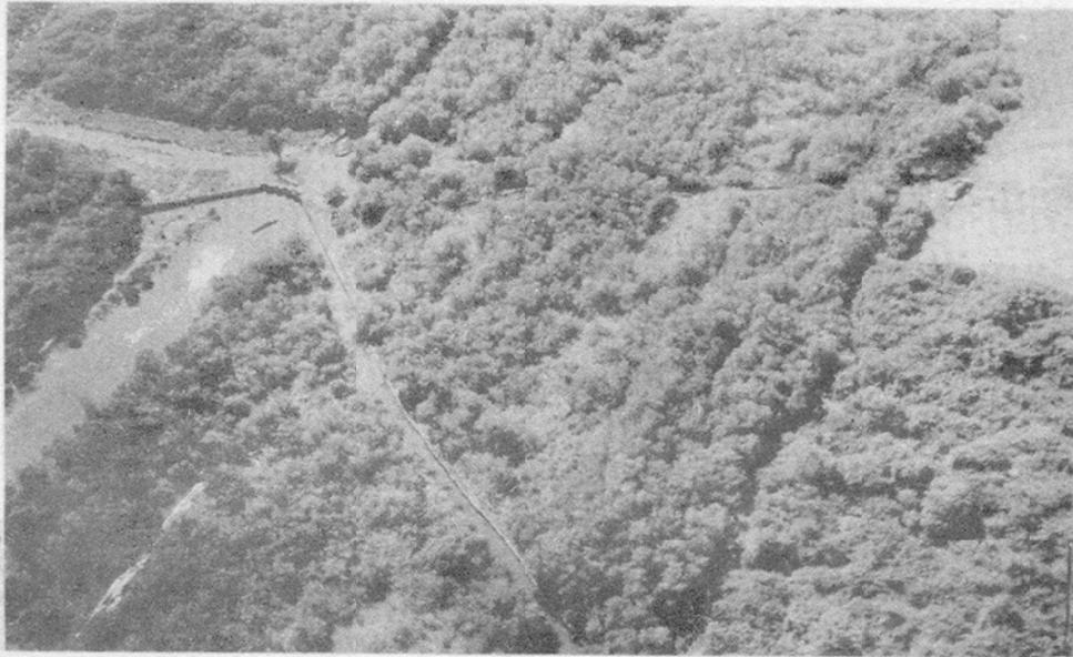
Foto 3. Vista aérea de un tapo para la captura de camarón. Nótese la forma en ángulo en cuyo vértice se construyen los chiqueros, así como la orejera derecha que encauza parte de las aguas del sistema. En el ángulo superior derecho puede apreciarse el sitio donde se concentra la producción del tapo.
