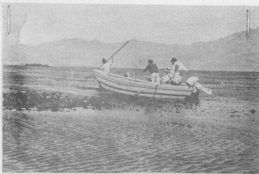
Foto 5 Pangón de madera de siete metros de eslora por dos metros de manga, utilizado en la captura de abulón.
