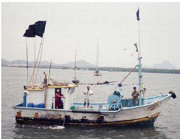
Fig. 1.- Barco palangrero de mediana altura usado para la pesca de tiburón por pescadores de Manzanillo, Col.
