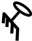
Figura 3. Manita de alambrón usada para la maniobra de subida de la captura abordo.
