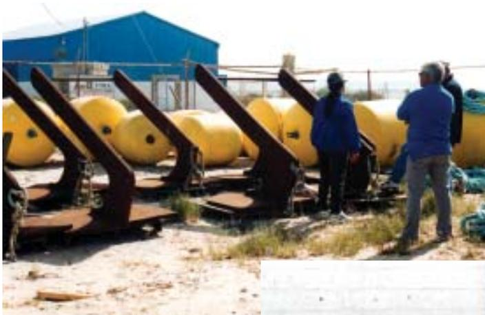
Foto 11.- Boyas, anclas y bloques de concreto de 3 toneladas utilizados en la fijación de las jaulas flotantes para el cultivo del jurel (*Seriola lalandi*) en Bahía Magdalena, B.C.S., México.
