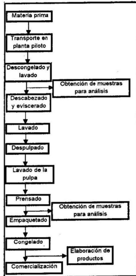
FIGURA 1. Diagrama de flujo para la producción de pulpa normalizada.
