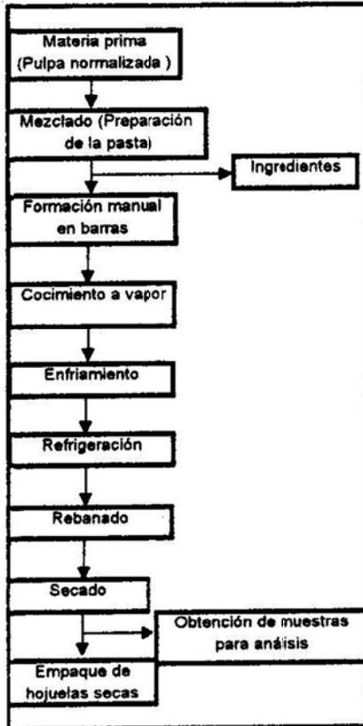
FIGURA 3.- Diagrama de flujo para la producción de fritura.
